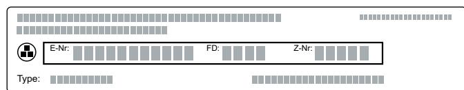
Номер изделия (номер E) указан также на стеклокерамической поверхности варочной панели. Вы можете проверить список сервисных центров (KI) и заводской номер (номер FD), зайдя в меню базовых установок. См. главу → "Базовые установки".
